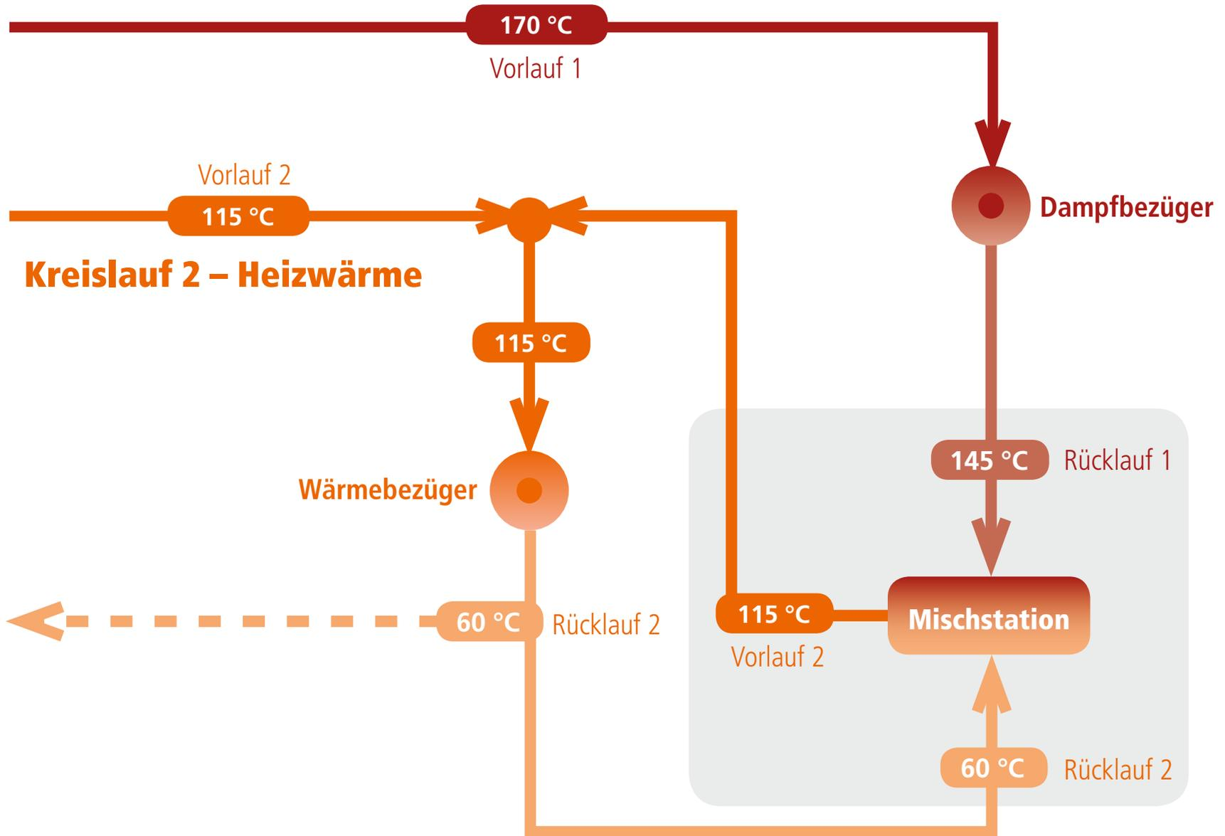
Die jeweilige Restwärme der Rückläufe von Kreislauf 1 und 2 werden in einer Mischstation zur Vorlaufwärme für Kreislauf 1 veredelt.
